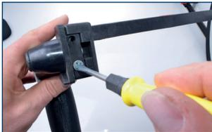
Schrauben Sie die Seitenkopfstütze B1 mit Schraube G auf die linke Seite des Halters A. Ebenso verfahren Sie mit Seitenkopfstütze B2 an der rechten Seite des Halters A. Der Schraubendreher kann durch Herausziehen zwischen Kreuzschlitz und Schlitz gewechselt werden.
